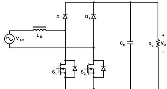
Fig: 5 Bridgeless PFC Boost rectifier
